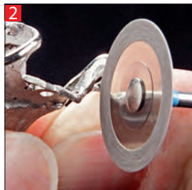
2 Обработка металлических каркасов. Trimming of metal framework.
